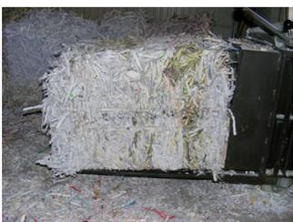
3. Schritt: Das Papier kommt geschreddert aus der Maschine und wird dabei zu Ballen gepresst.
